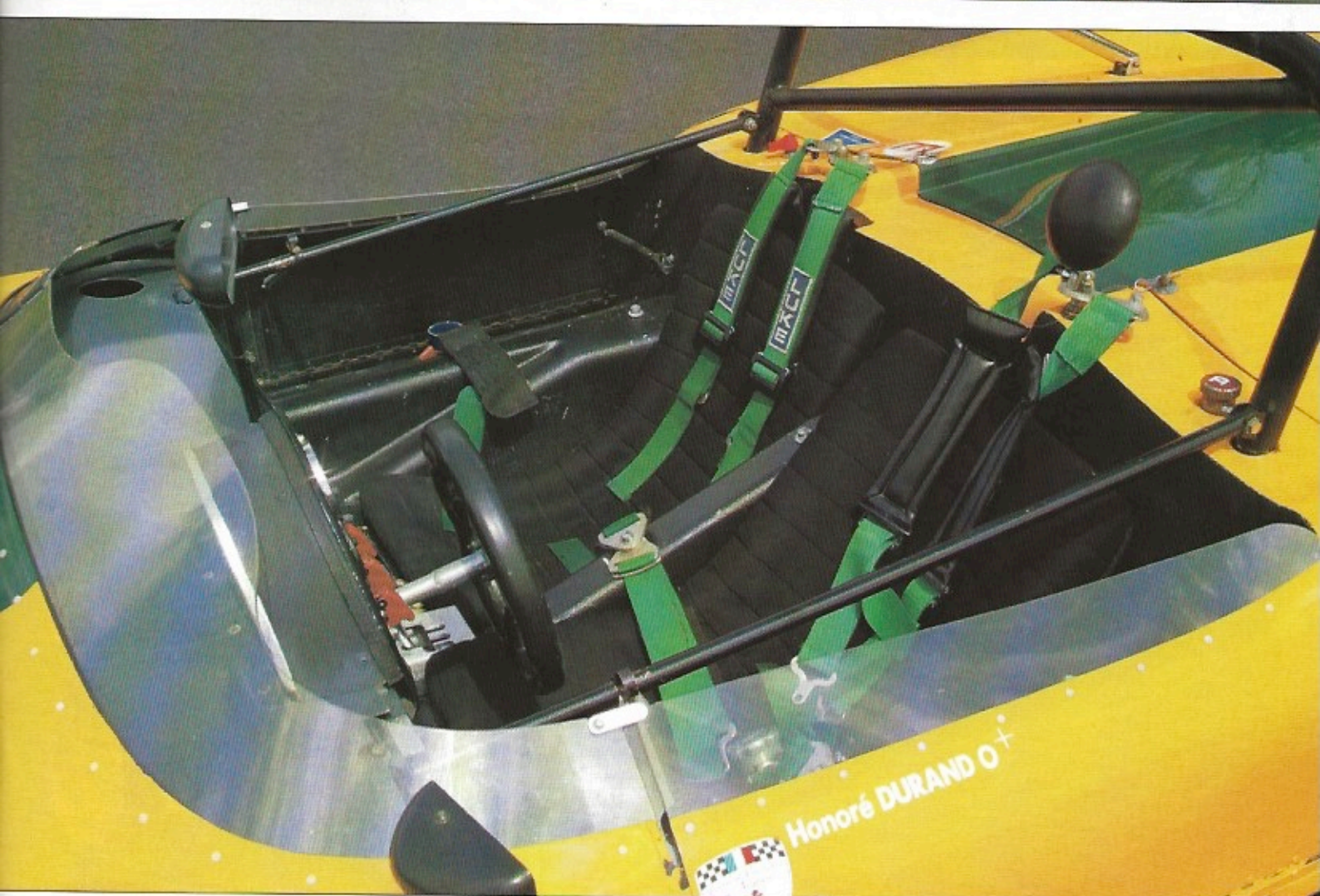
L'habitacle, biplace, avec à droite son réservoir de carburant homologué. On aperçoit les passages des tubes constituant le châssis. On note également l'arceau de sécurité et ses jambes de force arrière, qu'il faut démonter pour ouvrir le capot.
