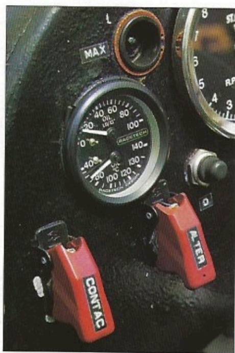
Le tableau de bord avec ses boutons protégés de contact et de commande d'alternateur.
